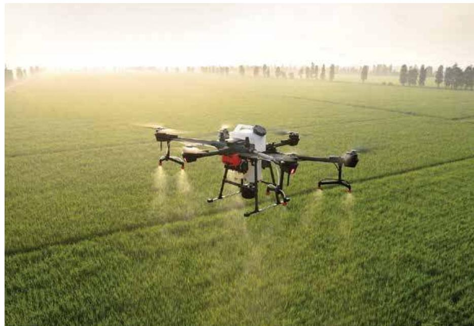
Il dosaggio variabile permette di fornire alle piante le sostanze di cui necessitano, con precisione, utilizzando droni e diverse piattaforme di sensori
